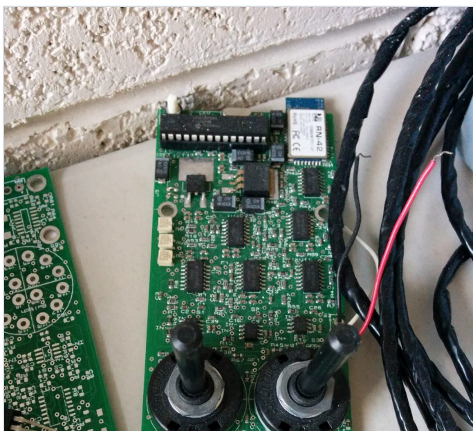
Fig. 13 La placa final, con el módulo Bluetooth RN-42.
