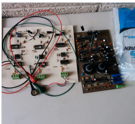
Fig. 10 Los primeros prototipos: del protoboard a una placa hecha a mano.
